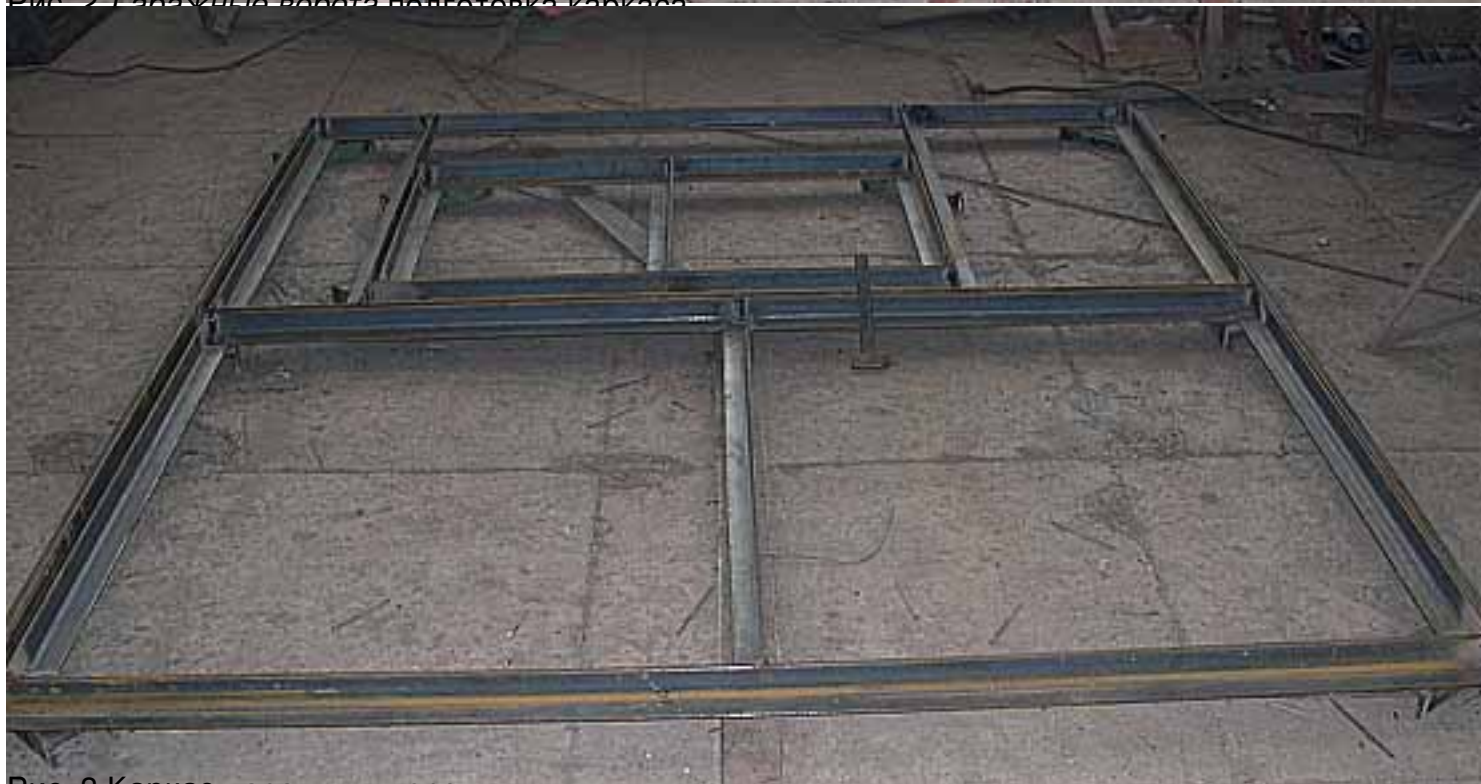
Рис. 3 Каркас гаражных ворот изготавливается из уголка
